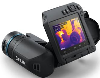
T540 | Profi-Wärmebildkamera mit Wechselobjektiven für Spezialanwendungen inkl. Trafo-Wartung
