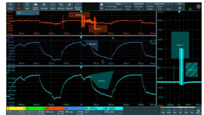
Power-Rail-Messungen mit Zone Trigger zur Isolierung von Stromverbrauchsereignissen während RF-Übertragungen
