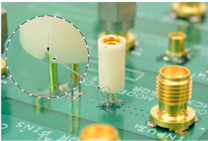
Abbildung 4: Ausrichten des MMCX-0,062-Zoll-Adapters (1,57 mm) an der Leiterplatte
