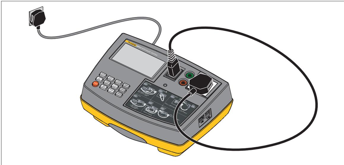
2. Zum Starten des Tests **IEC LEAD** drücken.
