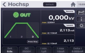
Funktion zur Prüfung der Durchschlagsfestigkeit
