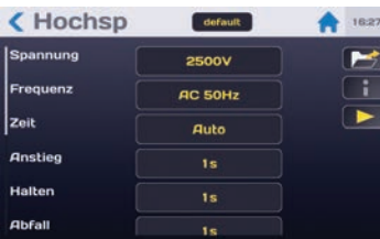
Konfiguration der Messparameter
