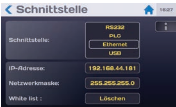
Konfiguration der Kommunikationsparameter
