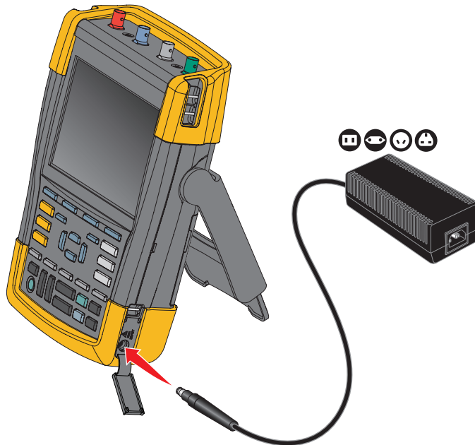
Abbildung 46. Laden der Akkus
