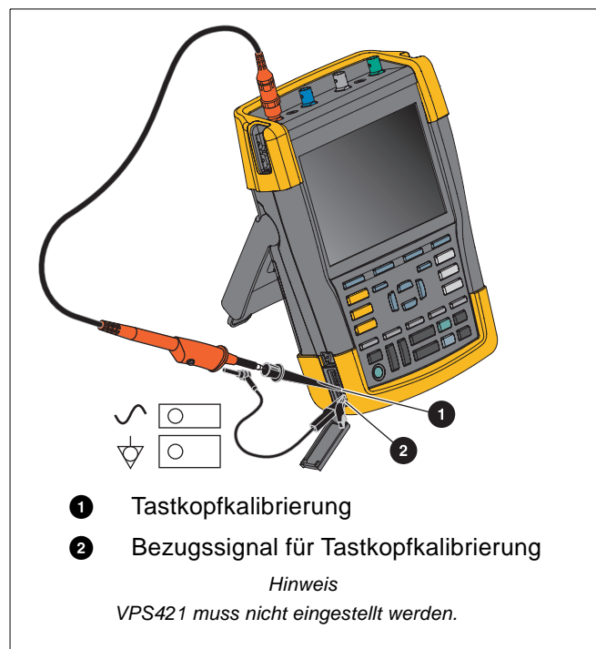
Abbildung 48. Einstellung des Spannungstastkopfes
