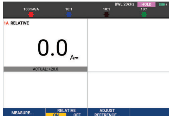
Abbildung 11. Durchführen einer Relativmessung
