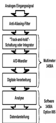
Abbildung E-1 Typisches Blockschaltbild eines Systems für digitale Signalverarbeitung; eine wichtige Voraussetzung für sinnvolle Ergebnisse ist die Vermeidung von Aliasing.
