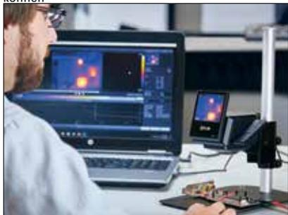
Stellen Sie über USB eine Verbindung mit einem Computer her und analysieren Sie Ihre Daten mit der FLIR Tools+ Software
